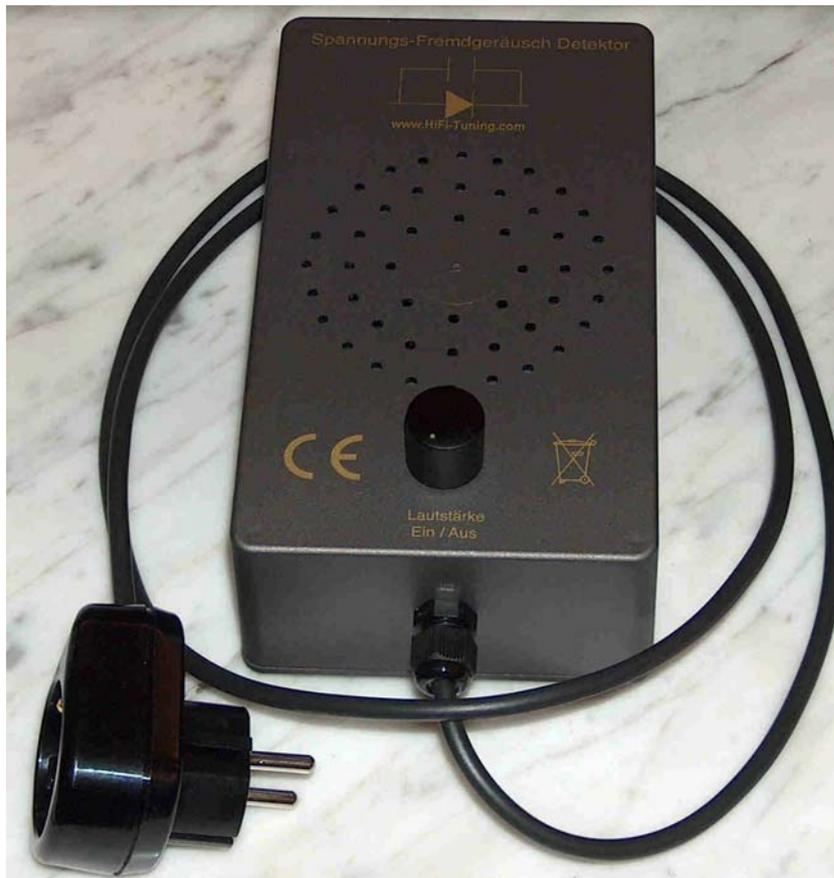
Der Spannungs-Fremdgeräusch-Detektor (SFD) ist ein Meßgerät das Stromnetz-Störungen (EMI/RFI) in Töne umwandelt. Abhängig von der Art der Störung (Schmal- oder breitbandig) hören sie ein Brummen oder Knistern. Mit dem Lautstärkereger kann man die Lautstärke einstellen, damit Sie untersuchen können, wie hoch das Störniveau ist. Um so lauter die Störungen hörbar sind, desto höher ist das Maß an Störungen.
